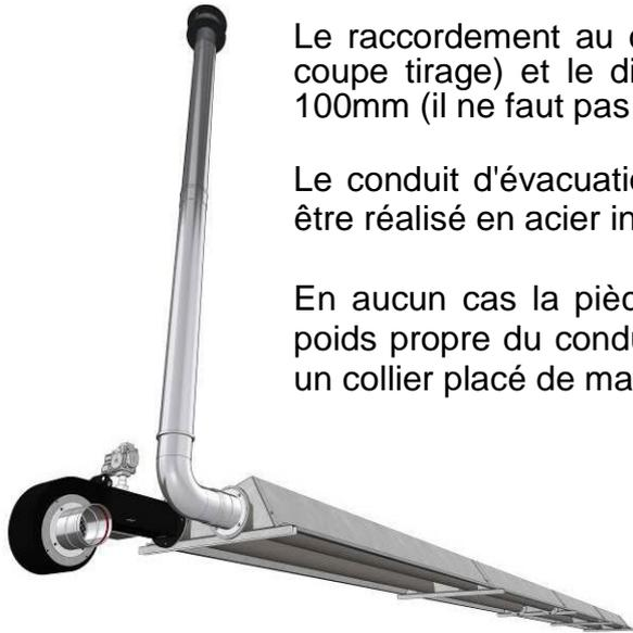
Le raccordement au conduit d'évacuation est de type direct (sans coupe tirage) et le diamètre du conduit d'évacuation doit être de 100mm (il ne faut pas réduire ce diamètre).
