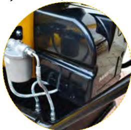
Zunanji filter. Predgrelnik goriva nameščen v glavi komore za izgrevanje.
