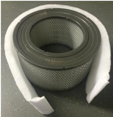
Abb. 4: Wechsel des Vorfilters
